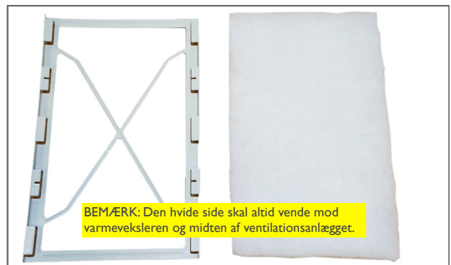
6. Den nye filtermåtte placeres med den glatte side ned i filterrammen
