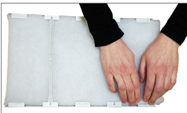
7. Filtermåtten klemmes omhyggeligt fast i filterrammen og skubbes godt ud i siderne. Filteret placeres igen i aggregatet med filtermåtten opad
